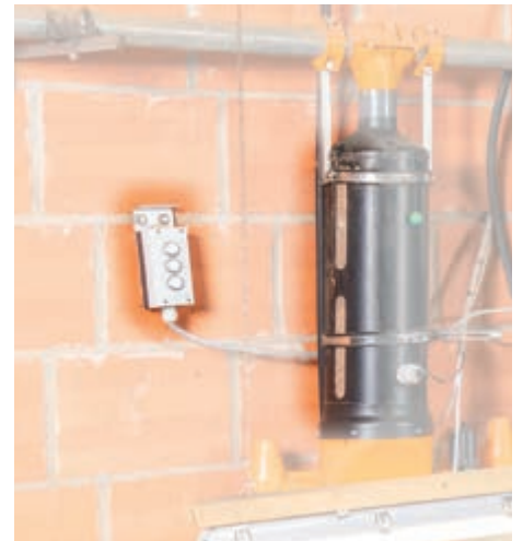
Manuelle Futterdosierung (optional); der Futterbehälter besitzt ein Sichtfenster zur Kontrolle des Futterfüllstandes
