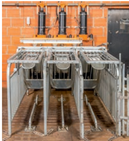
Ein Anti-Liegebügel verhindert, dass die Sau in der Station länger als nötig verweilt
