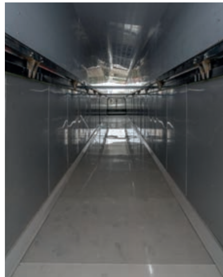
CompoLiner – überdacht und mit Edelstahl ausgekleidet
